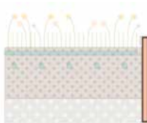
Isolering Artikelnummer: 21002 Växtbäddens sarger kan isoleras invändigt för att ge växtligheten ett ökat klimatskydd.
